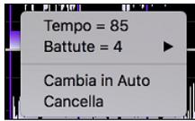
Puoi anche fare clic con il pulsante destro del mouse sul controllo per aprire un menu di scelta rapida con le opzioni per cambiare il tipo di indicatore (“utente” o “auto”), eliminare la linea di misura o impostare l'indicazione del tempo per la misura. Il menu mostra anche il tempo della misura, in base al ritmo della misura e alla posizione della misura successiva.
