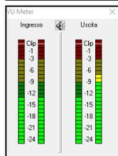
I **VU Meter** visualizzano il livello medio del segnale, con una scala in dB e con un indicatore di clipping. "Clipping" indica che il segnale è troppo forte e suonerà distorto ("clipped").
